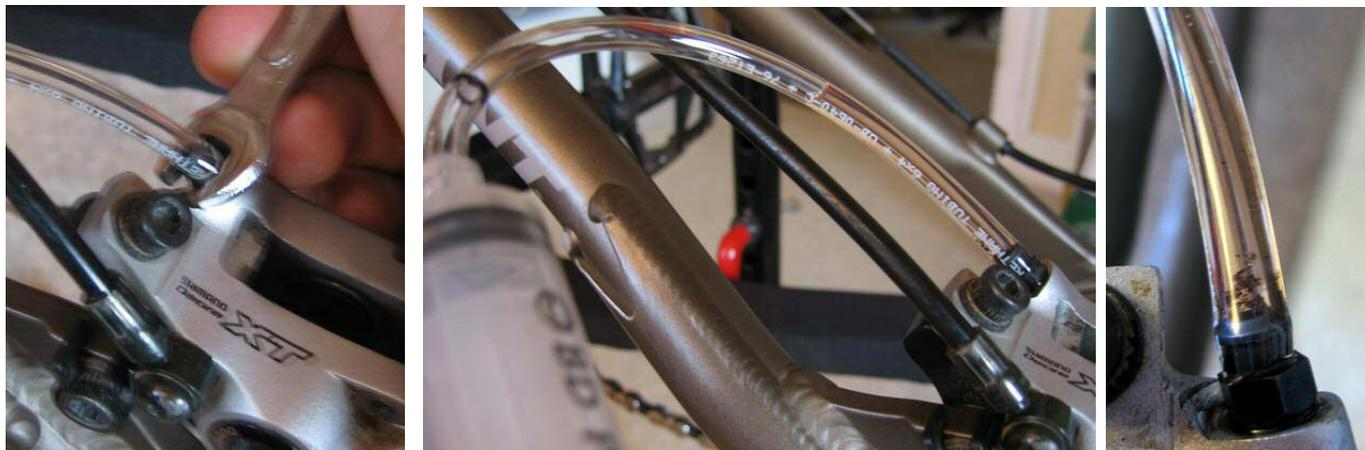
L'aspiration du liquide de frein dans la seringue fait baisser le niveau dans le vase d'expansion ; il faut donc remplir celui-ci en parallèle de la purge pour éviter que de l'air pénètre dans le circuit. Procéder alternativement : aspiration à la seringue avec contrôle visuel du niveau dans le vase d'expansion / mise-à-niveau de l'huile dans le vase d'expansion ; à répéter.
